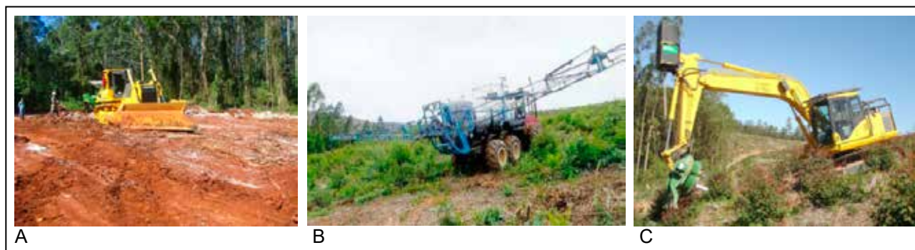
Figura 2. Preparo de solo com trator de esteira equipada com subsolador Savannah Bio Force, Mounted Plow (Arado Eco till - Bio Force) e V-Shear (Lâmina em forma de V para rebaixamento de tocos) (A); Aplicação de herbicida de longo alcance com polywarder (B); e, preparo do solo em áreas declivosas com escavadeira hidráulica com coveador Rotree (C).
