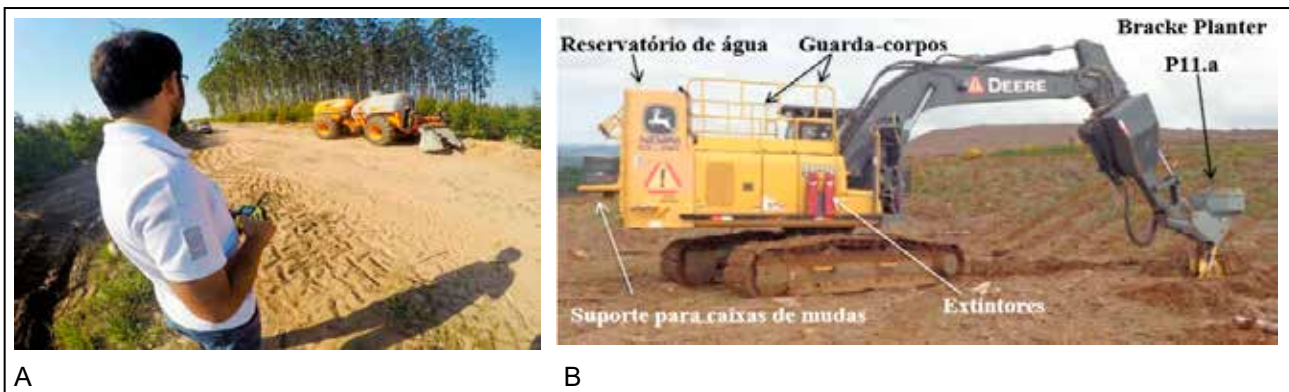
Figura 3. Trator autônomo na aplicação de herbicida (A) e Conjunto plantador adaptado para operação de plantio mecanizado (B).
