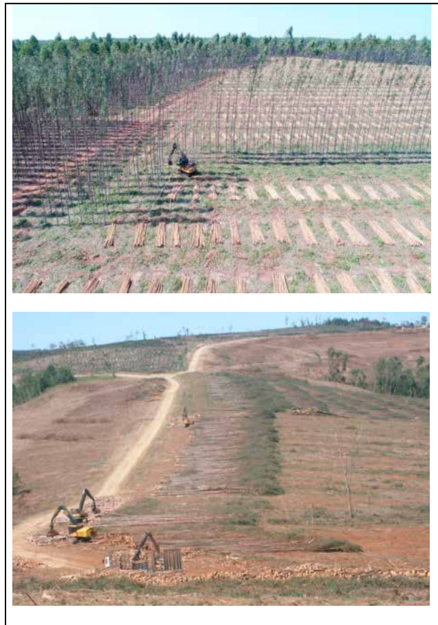
Figura 1. Sistema de colheita da madeira cut to length e full tree
