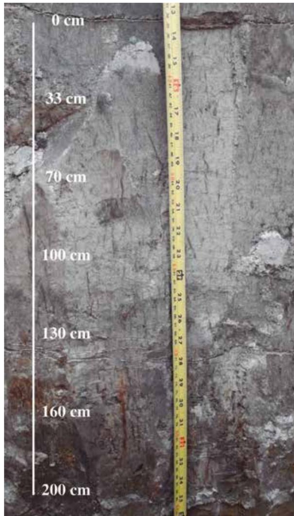
Figura 26. Profundidades de toma de muestras para el análisis de textura en la calicata principal
