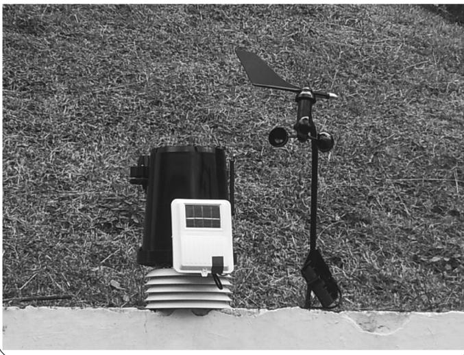
*Fuente: Estas estaciones recabarán los datos meteorológicos una vez por minuto, y los transmitirán a un servidor central (instalado en la UCR. Prosic, 2012 (Cortesia de Teresita Coto).*
