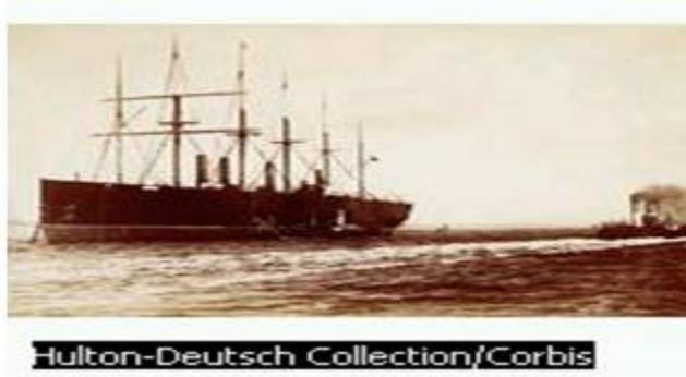
El *Great Eastern*, botado en 1858, fue durante mucho tiempo el mayor buque de vapor del mundo, hasta que fue superado por el *Oceanía* en 1899. Tenía 211 m de eslora y estaba impulsado por ruedas de palas, una hélice y seis velas auxiliares. Se le recuerda sobre todo por haber tendido el primer cable telegráfico trasatlántico, el mismo año de su botadura. (Imagen de arriba)
