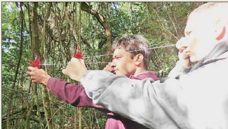
Estudiante de la Carrera de Ingeniería Ambiental y un técnico de la Reserva Kanguery, realizando las mediciones de Área Basal de los árboles con un relascope "LUDE", con la metodología Bitterlich.
